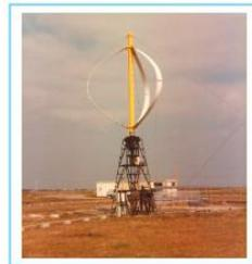
Figure 13 - Prototype français axial de machine Darrieus 0,8 MW (Source : Centre National d'Études de l'Énergie, 1985, sous licence)
