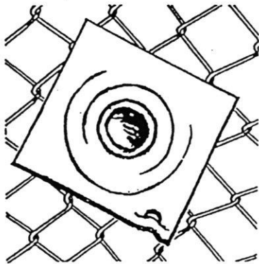
Renforcement avec grillage et plaque d'appuis des boulons
