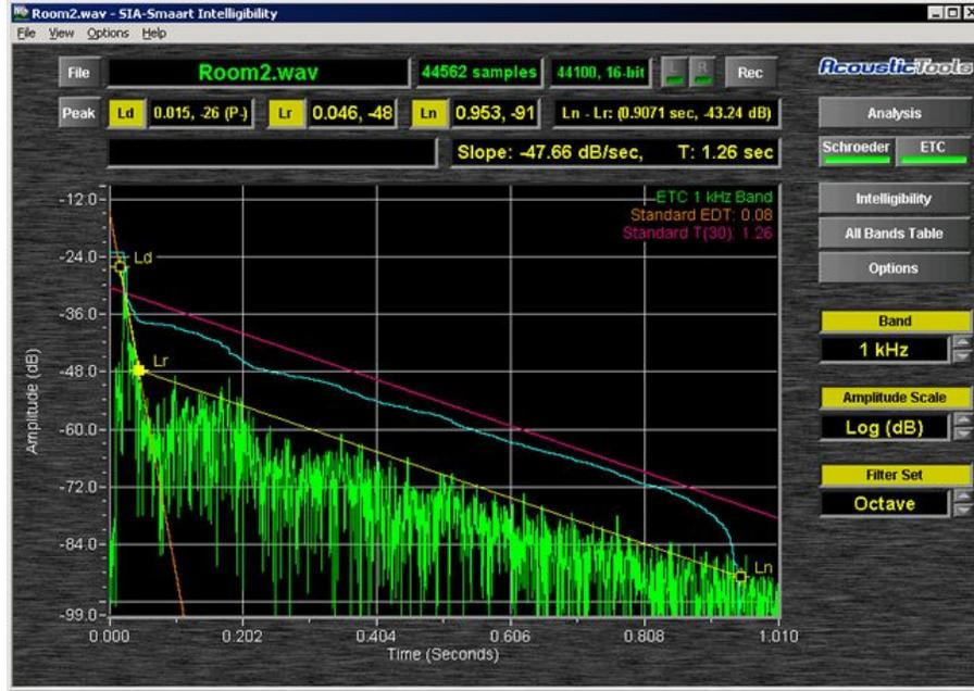
FIGURE 11.8 – Mesure du temps de réverbération.
