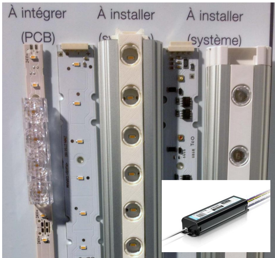
LED(s) + électronique d'alimentation
